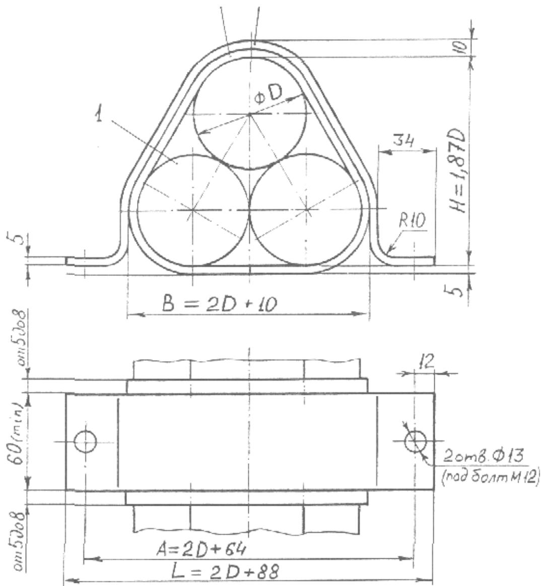
Рисунок А3. Крепление трёх кабелей в связке на металлоконструкции (вариант исполнения)
