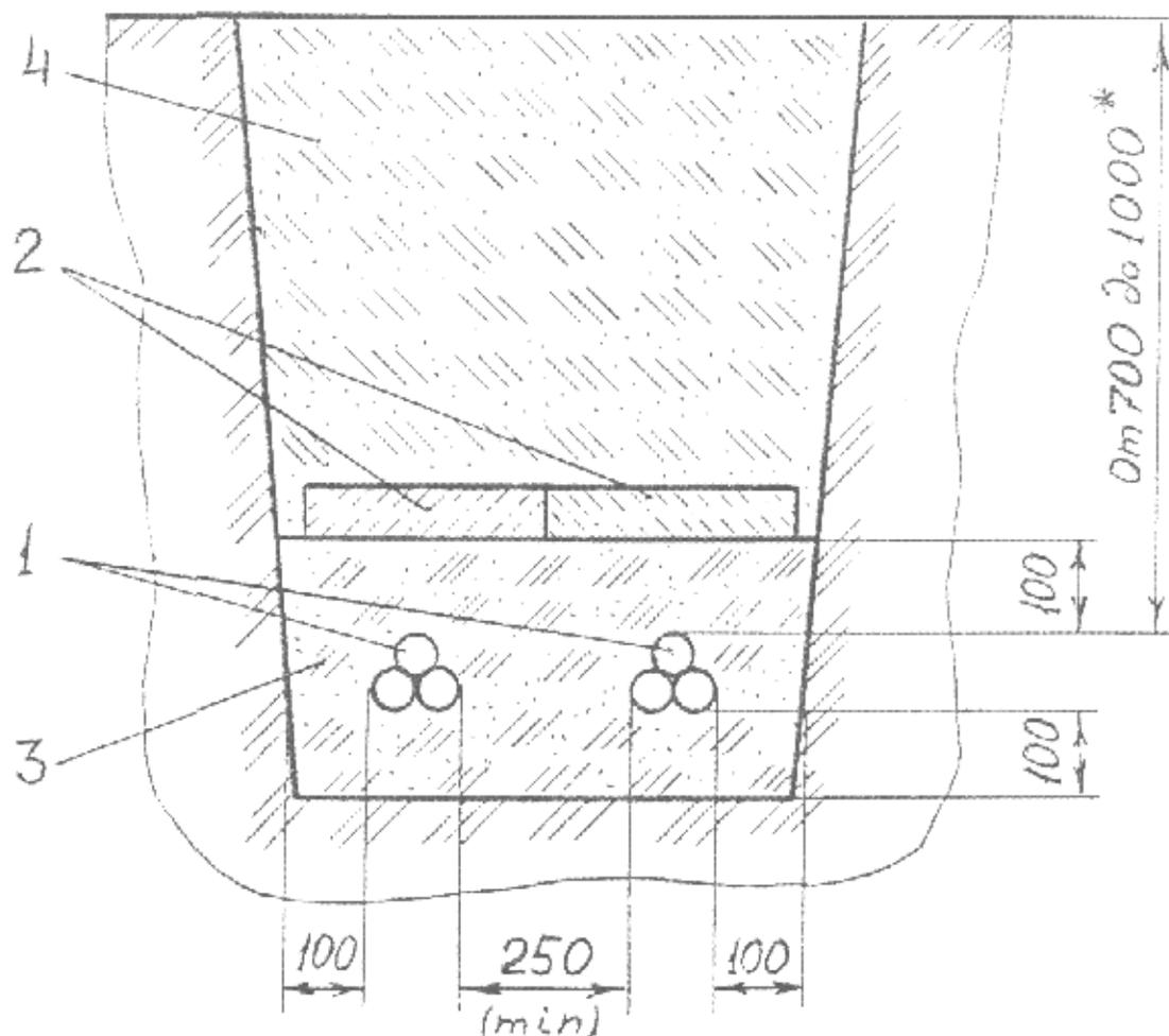
Рисунок А2. Прокладка кабелей 20 и 35 кВ в траншее, расстояние между кабельными линиями при параллельной прокладке в земле
