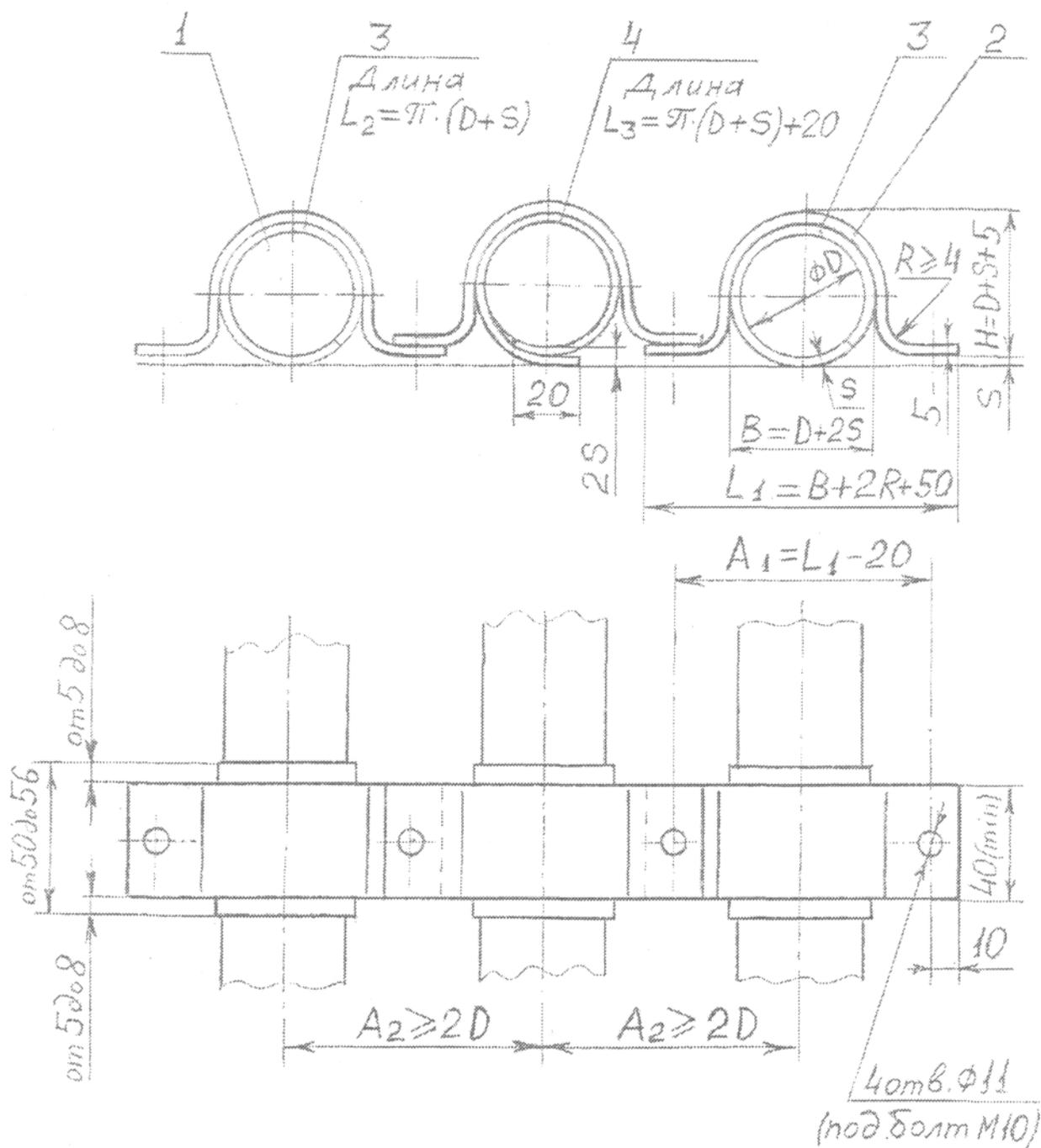
Рисунок А5. Крепление трёх кабелей на металлоконструкции
