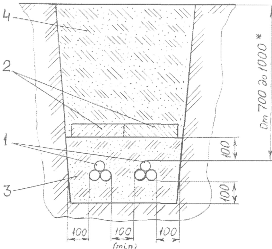
**Рисунок А1 Прокладка кабелей 10 кВ в траншее, расстояние между кабельными линиями при параллельной прокладке в земле**
