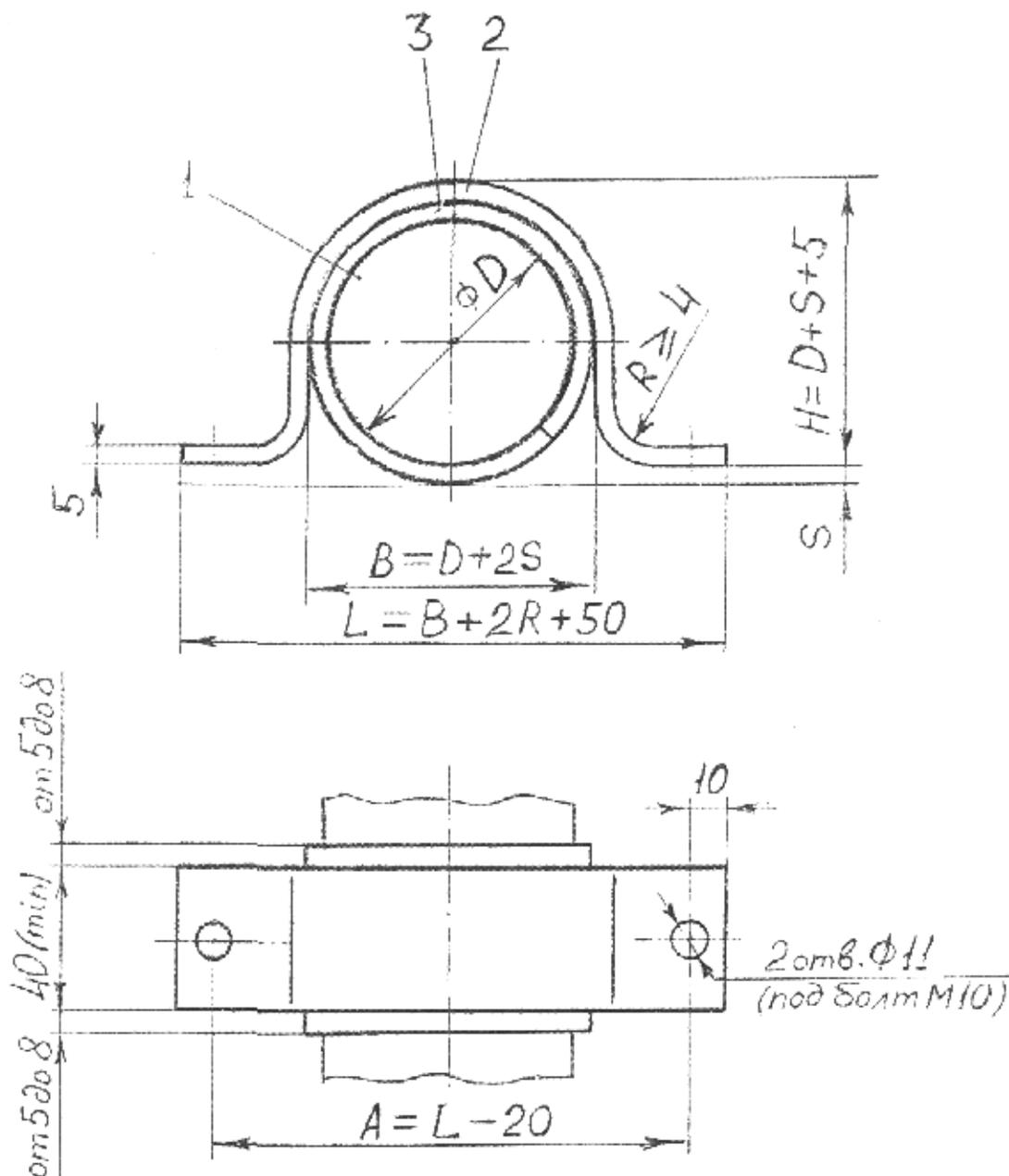
Рисунок А4. Крепление одного кабеля на металлоконструкции
